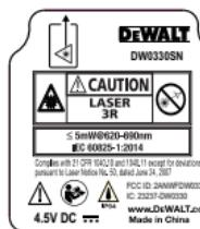
As ferramentas DW0165N/DW0165S/DW0330SN emitem um feixe laser visível, como indicado na Figura A ①. O feixe laser emitido é de classe 2/3R de acordo com a IEC 60825-1 e está em conformidade com 21 CFR 1040.10 e 1040.11, exceto os desvios indicados no aviso relativo ao laser n.º 50, de 24 de junho de 2007.
