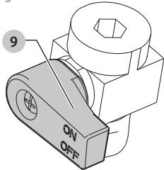
7. Une fois la vidange de l'eau terminée, fermez le robinet de vidange (tournez dans le sens des aiguilles d'une montre). Le compresseur d'air peut maintenant être rangé.
