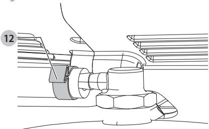
6. Quite los tres tornillos de montaje de la bomba que sujetan la bomba.
